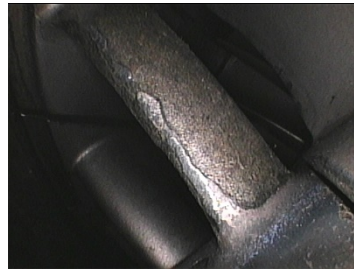
渦輪葉片塗層(coating)剝落、裂痕、破裂
